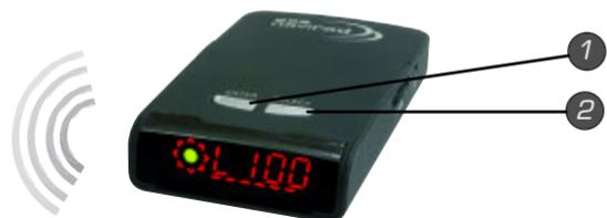
För att kontrollera funktionen hos din GPS Navirad, kan du starta autodemonstrations-funktionen genom att trycka in de båda knapparna samtidigt i 3 - 4 sekunder. Med detta funktionssätt kan du testa samtliga meddelanden, ljud och visningar. För att överge autodemonstrationsfunktionen, tryck återigen på knapparna "ENTER" + "SELECT" ända tills ordet "END" visas med hög ljusstyrka på displayen.
