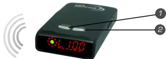
Pour contrôler le fonctionnement de votre GPS Navirad, vous pouvez lancer le mode d'auto démonstration en pressant les deux boutons simultanément pendant 3 à 4 secondes. Ce mode vous permet de tester l'ensemble des messages, des sons et des affichages. Pour quitter le mode d'auto démonstration, pressez à nouveau les boutons "ENTER" + "SELECT" jusqu'à l'apparition du mot "END" sur l'écran haute luminosité.
