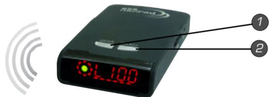
Para controlar el funcionamiento del GPS Navirad, puede activar el modo de demostración pulsando los dos botones simultáneamente durante 3 ó 4 segundos. Este modo permite probar todos los mensajes, sonidos y visualizaciones. Para salir del modo de demostración, pulse de nuevo los botones "ENTER" y "SELECT" hasta la visualización del mensaje "END" en la pantalla.
