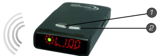
Zur Prüfung der Funktionsfähigkeit des Geräts den Selbstdarstellungsmodus starten. Hierfür gleichzeitig die Tasten "SELECT" und "ENTER" 2 bis 3 Sekunden lang gedrückt halten. In diesem Modus können Sie alle Meldungen, akustischen Signale und Anzeigen testen. Zum Schließen des Selbstdarstellungsmodus drücken Sie erneut die Tasten "ENTER" + "SELECT", bis das Wort "END" auf dem Leuchtdisplay erscheint.
